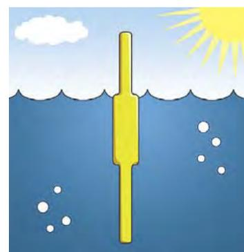
无吸收性的档栅具有 305mm 的吃水线，有助于避免油污散落。
