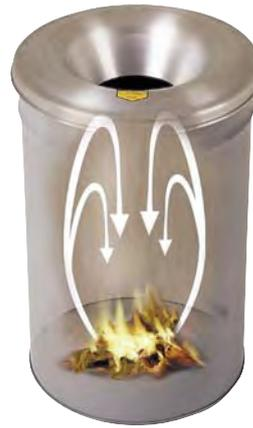
注：如果着火，灭火桶盖将上升的燃烧废气送回并积压在盖口下方，切断氧气供应，实现灭火。
