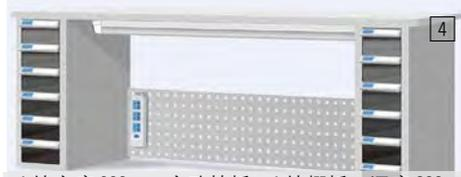
1 块高度 600 mm 方孔挂板, 1 块棚板, 深度 300 mm。1 组 40 W 灯具, 2 只移动插座组, 各 3 座 220 V, 1 只开关。
