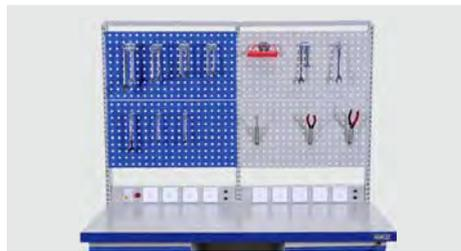
[17] 含 1 组双单元立柱框架, 宽 1500x 高 1359mm, 4 块方孔挂板, 宽 750x 高 390mm, 1 组电源集成板。
