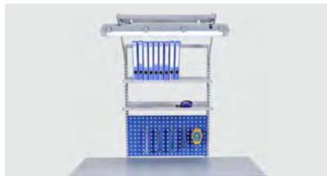
[14] 含 1 组立柱框架, 宽 750x 高 1359mm, 1 块方孔挂板, 宽 750x 高 390mm, 1 块钢制搁板, 深 400mm, 1 块钢制搁板, 深 300mm, 2 块侧挡板, 1 组三防封闭照明灯 1x36W。
