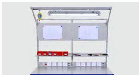
[18] 含 1 组双单元立柱框架, 宽 1500x 高 1359mm, 2 块文件看板, 宽 750x 高 390mm, 2 块钢制搁板, 深 300mm, 1 组集成电源板, 1 组三防封闭照明灯 1x36W。
