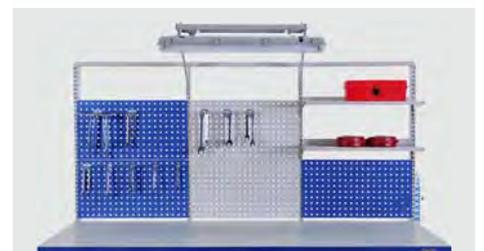
[22] 含 1 组三单元立柱框架, 宽 2250x 高 1359mm, 5 块方孔挂板, 宽 750x 高 390mm, 2 块钢制搁板, 深 300mm, 1 块移动电源插板, 1 组三防封闭照明灯 2x18W。
