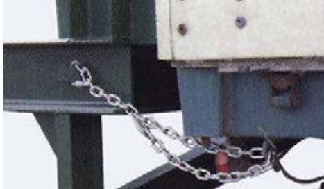
货车相连安全防护链
